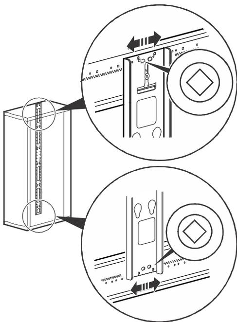
1. 将背面缆线通道放置在机柜的侧支架上，确保背面缆线通道接头背面的三个接插头插在机柜的侧支架上。
